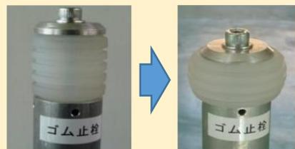
テストパイプ先端のラバーバルーンがポンプ加圧されることによって点検ホース内部で拡張し、ホースを傷つけずに止水します。
